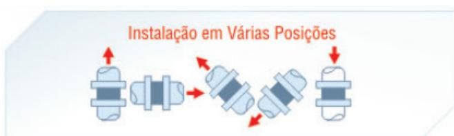
Podem ser montadas em qualquer posição, observando-se apenas a seta indicadora do fluxo no corpo.
