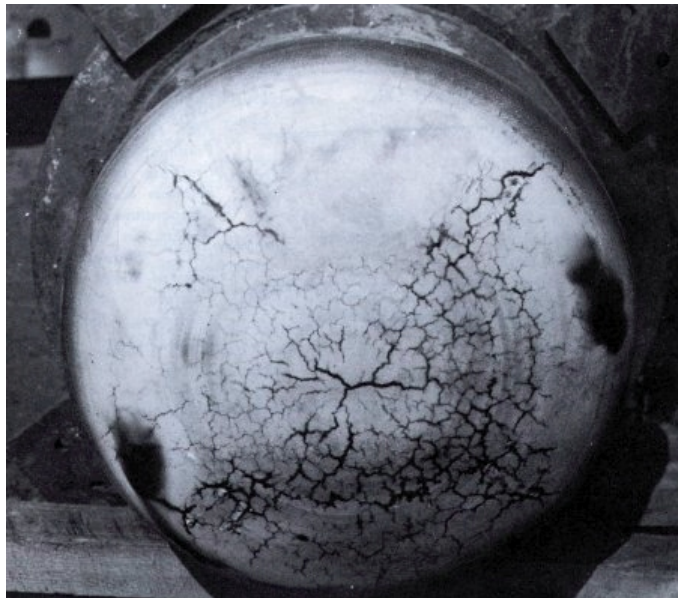
Fig. 10 - Corrosão sob tensão em uma autoclave de aço 304.
